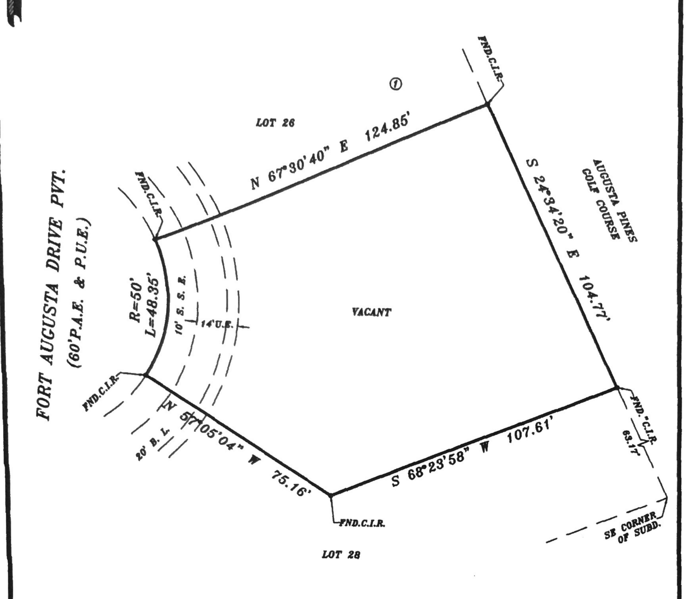
NOTE: BEARINGS ARE BASED ON RECORDED PLAT.
