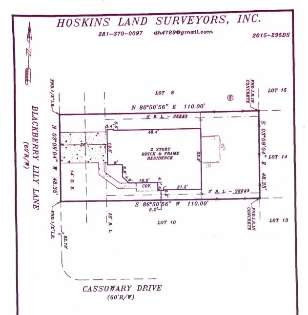
NOTE: BEARINGS ARE BASED ON RECORDED PLAT.
