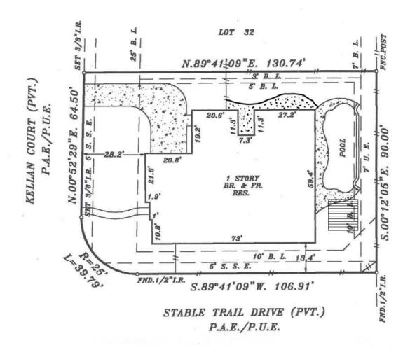
NOTE: BEARINGS ARE BASED ON RECORDED PLAT.
