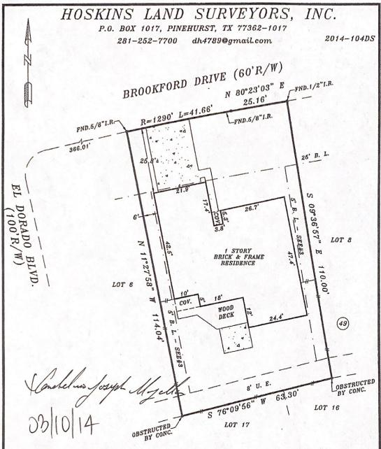
NOTE: BEARINGS ARE BASED ON RECORDED PLAT.
