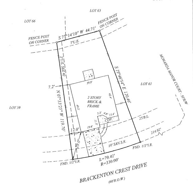
NOTE: BEARINGS ARE BASED ON RECORDED PLAT.
