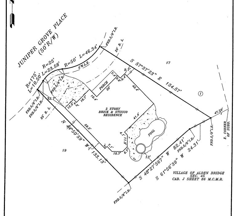
NOTE: BEARINGS ARE BASED ON RECORDED PLAT.
