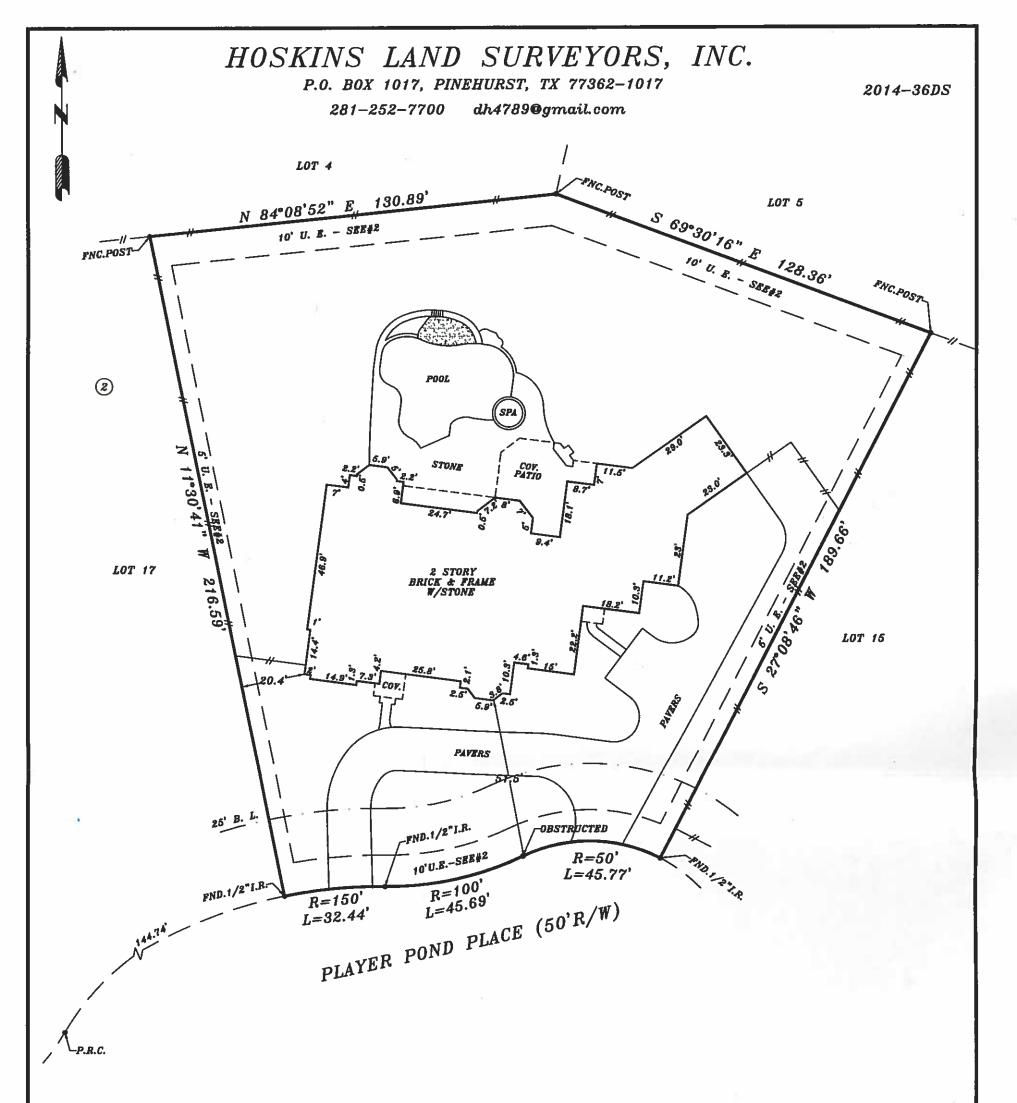
NOTE: BEARINGS ARE BASED ON RECORDED PLAT.
