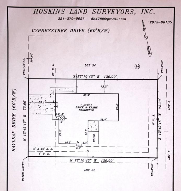
NOTE: BEARINGS ARE BASED ON RECORDED PLAT.
