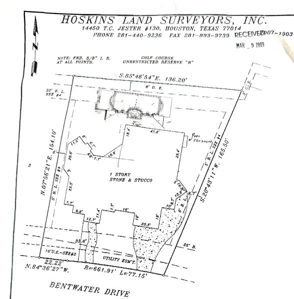
NOTE: BEARINGS ARE BASED ON RECORDED PLAT.
