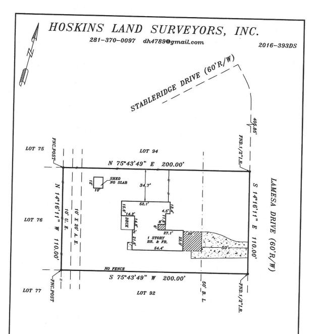
NOTE: BEARINGS ARE BASED ON RECORDED PLAT.
